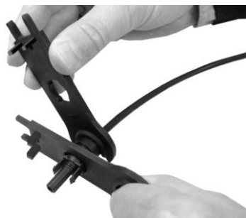
Figura 32 - Aperto do prensa cabo
